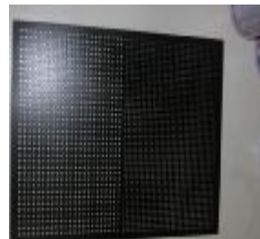
用于大幅面散斑制备的漏板
