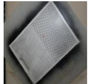
喷有圆点散斑的试件
